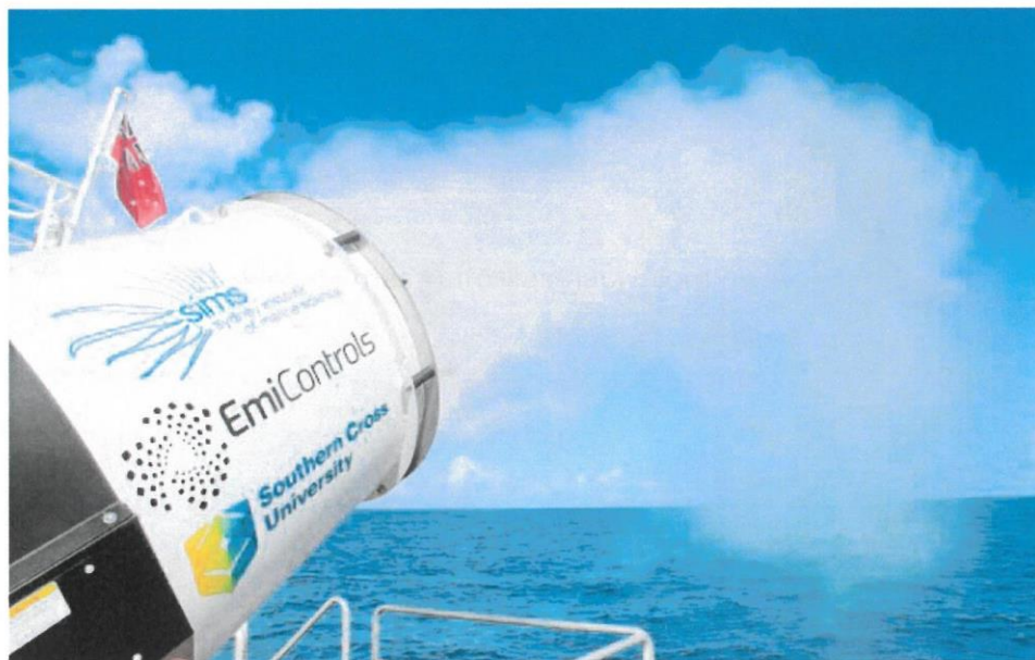
El cañón pulverizador que se usó en la Gran Barrera de Coral en 2020, en el primer experimento con sal marina // ABC
