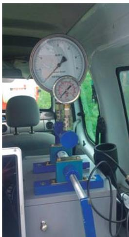
Se hará especial énfasis en el manómetro, se testeará su precisión y que la escala y resolución son las adecuadas.
